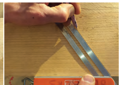
Fig. 5. Transporte y marca de ángulo H. Fuente: autor.
